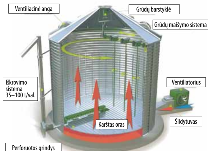
Grūdų sandėliavimo bokšto su maišymo įranga veikimo schema
