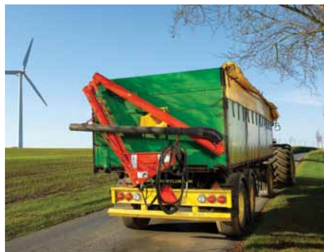
B-16 tipo sraigtinis transporteris, montuojamas prie sunkvežimio galo
